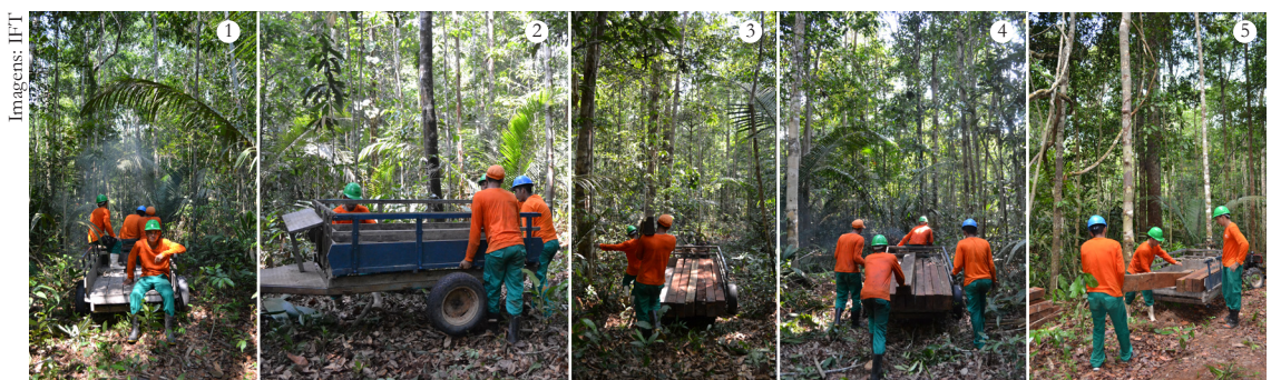
Figura 5: Etapas do transporte primário (arraste) com microtrator.
