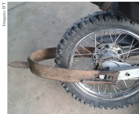
Figura 6: Rabicho adaptado e carretinha utilizada para o transporte de pranchas de madeira.
